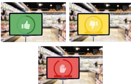
3Dセンサーで計測した来店数をディスプレイへリアルタイムに信号機のような緑・黄・赤色で表示。また、注意（黄色）と規制（赤色）の表示人数設定が可能。ディスプレイの表示が変わることで、お客様の行動変化を促します。
